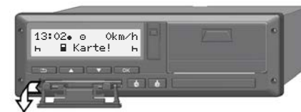
att. 11: Pārsega nolaišana
