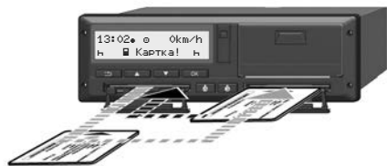
Мал. 35: Заміна картки водія
