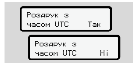
Мал. 116: Ні – індикація за місцевим часом
