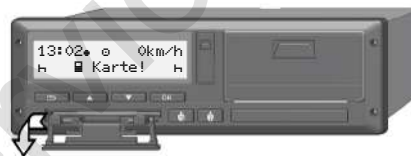
att. 11: Pārsega nolaišana
