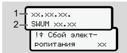
Рис. 130: Индикация - Сбой электропитания
