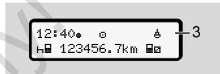
Рис. 119: Стандартная индикация - Поездка на пароме/поезде
