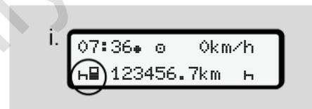
Рис. 24: Стандартная индикация с установленной картой
