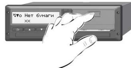
Рис. 125: Нажать клавишу разблокировки
